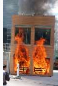
Essai au feu (CSTB 2009) pour paroi d'école en ossature bois isolés de paille
